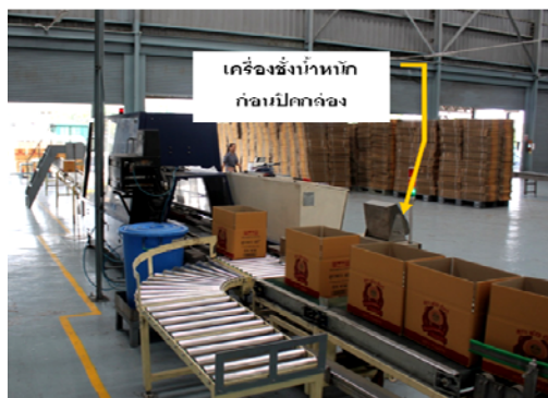
รูปที่ 4-17 เครื่องชั่งอัตโนมัติเพื่อตรวจสอบน้ำหนักสุรา
